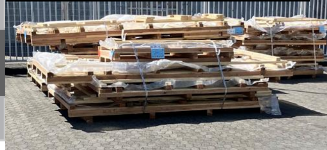
⑧空箱・空スキッドのバンド掛け
